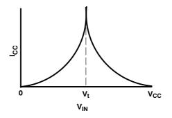
Figure 2. V<sub>IN</sub> vs I<sub>CC</sub>
