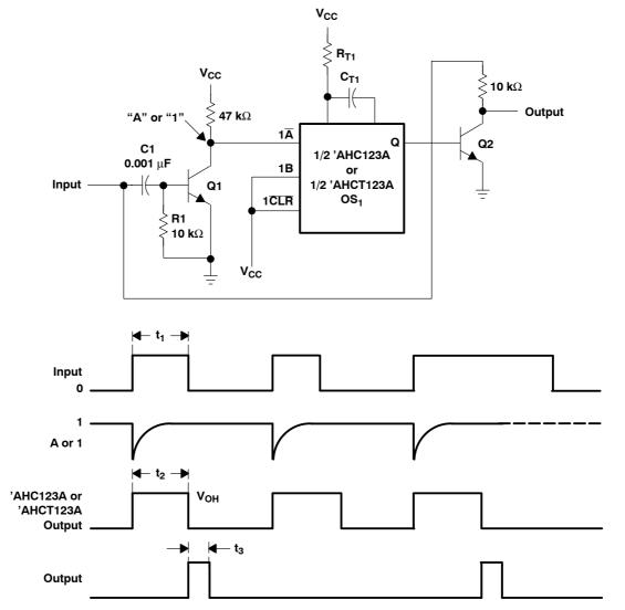
Figure 13. Pulse-Duration Detector
