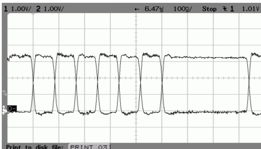
Obr. 5 - Diferenciální přenos na vodičích D+ a D-
