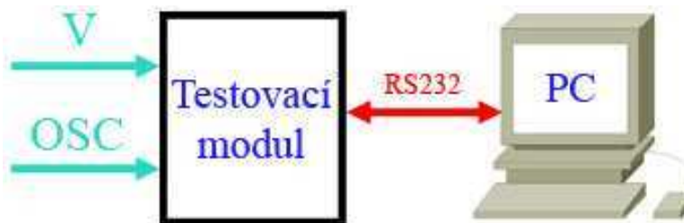
Obr. 2.7 Blokové schéma měření voltmetrem a osciloskopem
