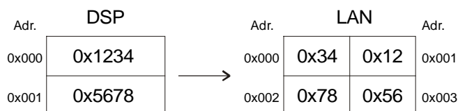
Obr. 5.15 Překlad adres mezi DSP a LAN
