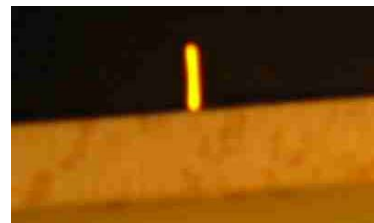
Obr. 9.10 Fotografie difusního zdroje překrytého RTG filmem
