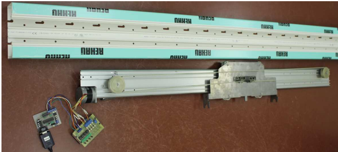
Obr. 107 Konstrukce pojízdné optické lavice
