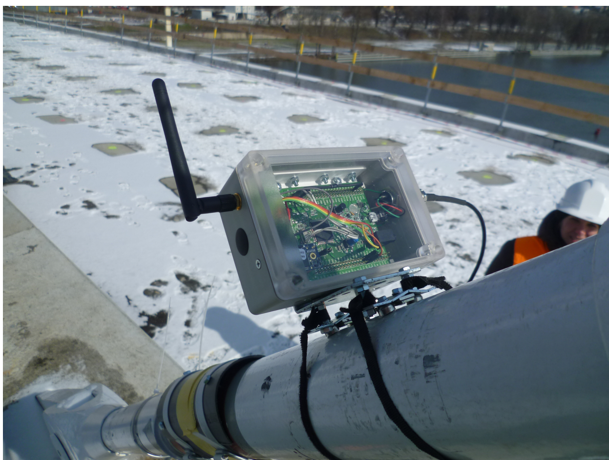
Obr.4.24. Měřicí přípravek při testech na táhle Trojského mostu.
