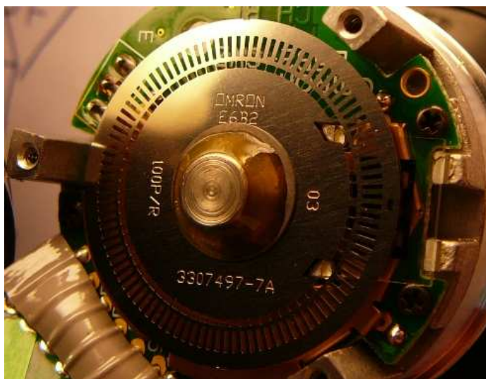
Obr. 8.1 Fotografie enkodéru Omron s rozlišením 100 pulsů na otáčku.
