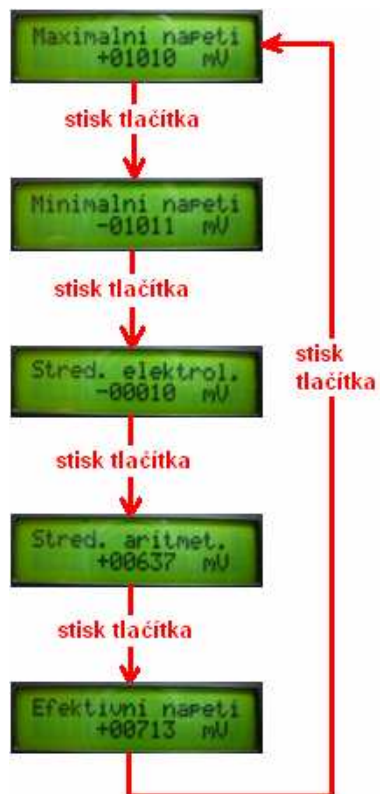
Obr. 4.5 Vlevo zapojení testování modulu voltmetr, vpravo schéma menu přístroje.
