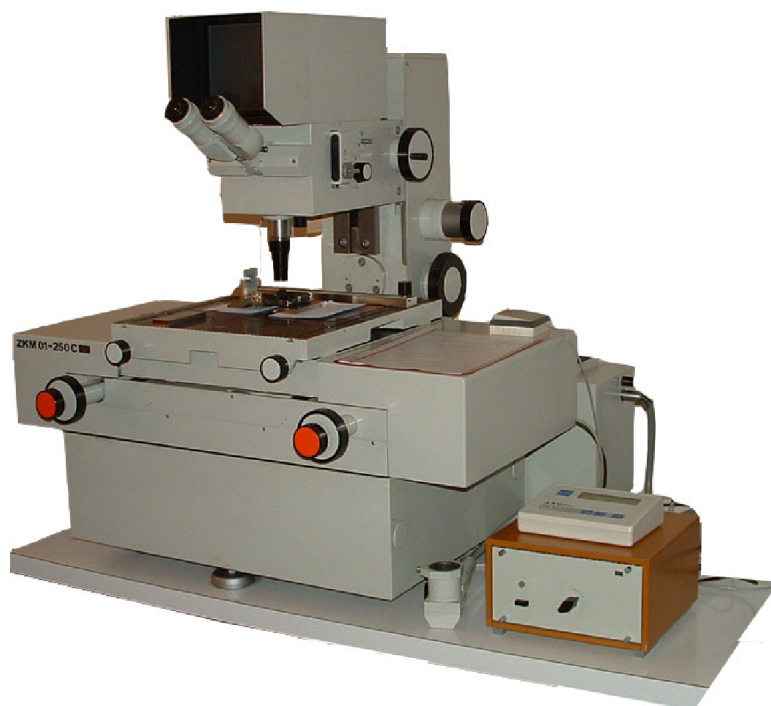
Obr. 11-15 Mikroskop Carl-Zeiss ZKM01-250C s digitálním indikátorem polohy (napravo)
