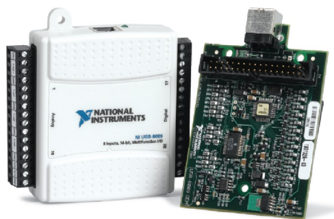
Obrázek 2.3: Univerzální měřící deska NI 6008 ve verzi se šroubovacími konektory a OEM verzi [2]
