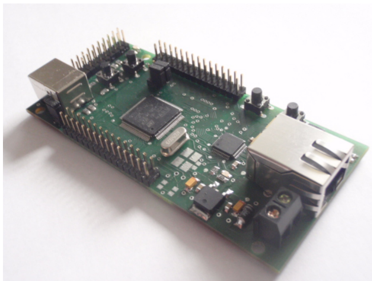
Obrázek B.8: Osazený modul pro distribuovaný sběr dat
