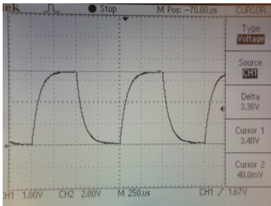
Obrázek 7.8: Amplituda signálu U_{in}(t) (měřeno osciloskopem Tektronix TDS 210)
