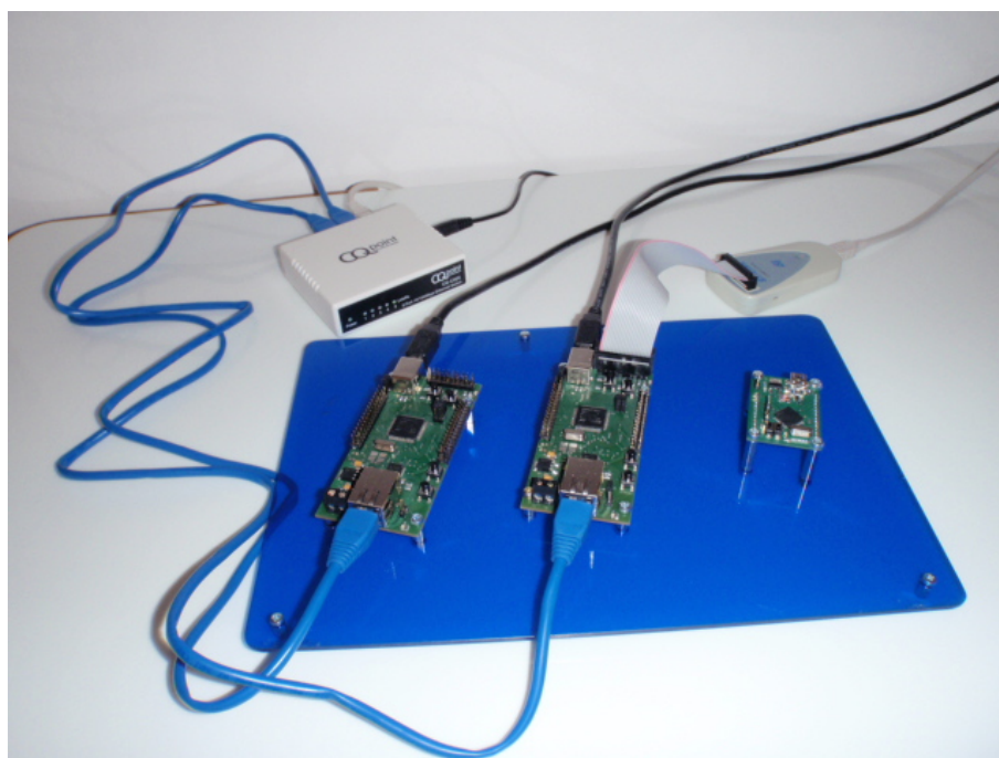
Obrázek B.11: Připojení dvojice modulů k síti Ethernet
