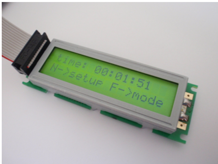
Obrázek B.5: Zobrazení údajů na displeji jednotky digitálních hodin
