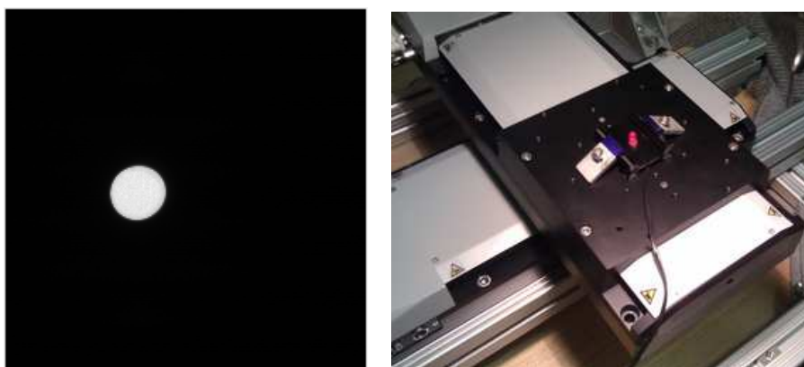
Obr. 4.25 Vlevo snímek z kamery světelného bodu, vpravo snímek upevnění diody na pojezd
