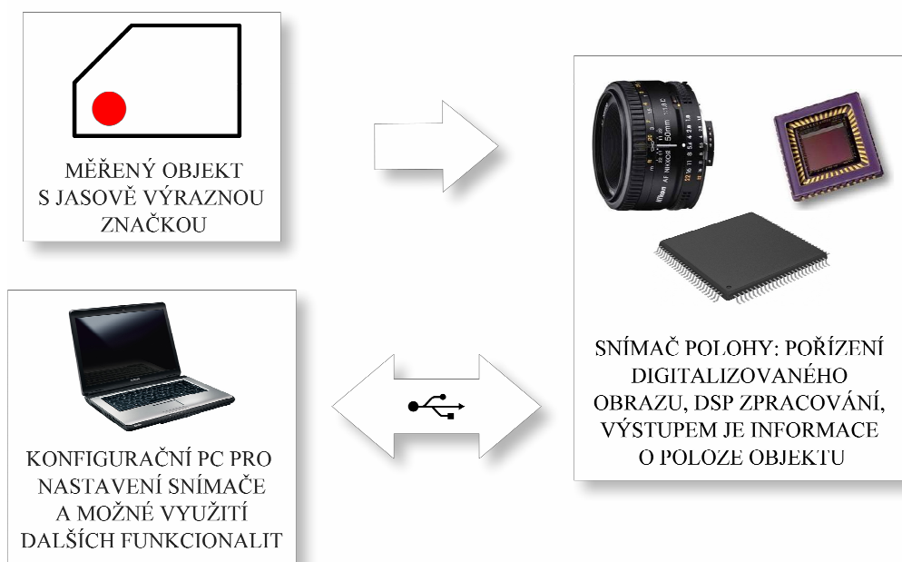
Obr. 2.1 Blokové schéma měření polohy obrazovým senzorem
