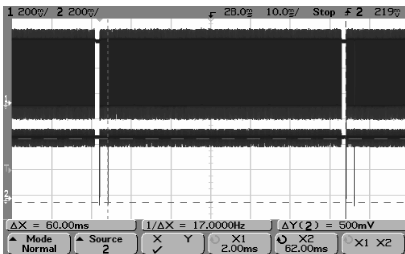
Obr. 6.6 - Integrační doba 60ms: 1.signál – CLK, 2.signál – ROG
