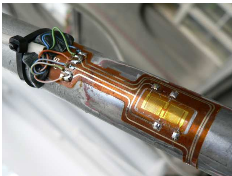
Obr.1.4 Nalepený tenzometr na táhle
