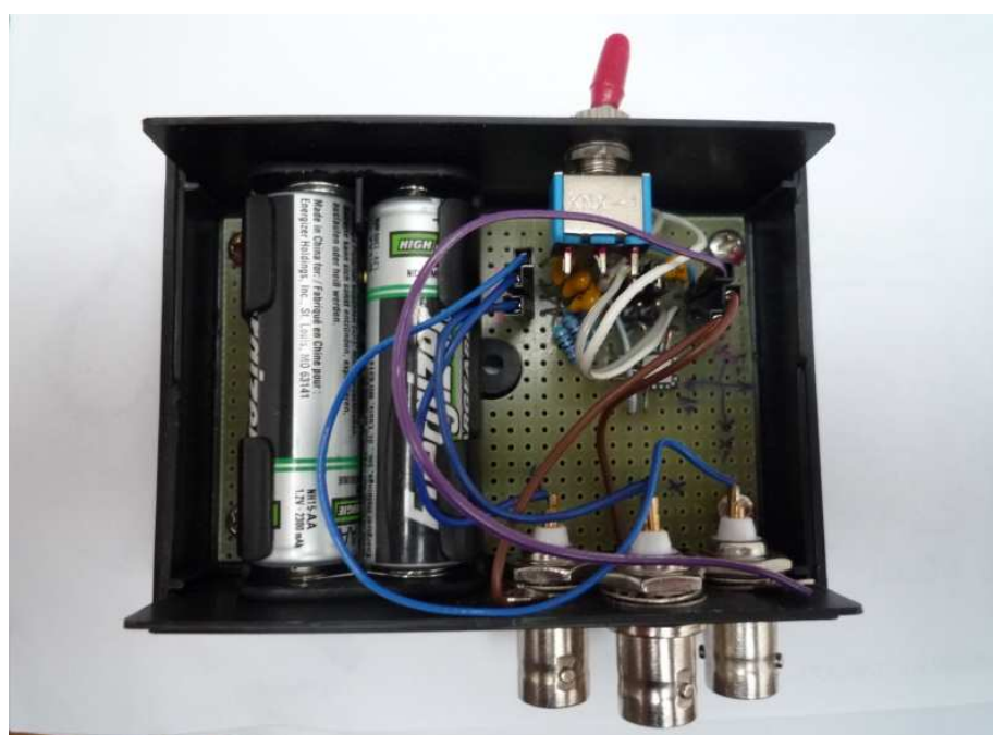
Obr. 1.6 Přípravek pro ověření vhodnosti akcelerometru
