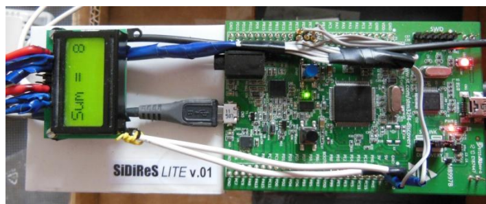
Obr. 26 - Pohled na systém SUMONDI seshora - senzor pod Discovery kitem
