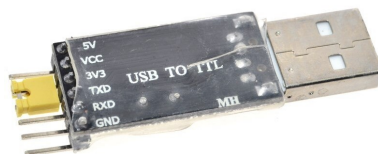
Obrázok 4.14. Prevodník UART-USB typu CH340
