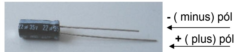
elektrolytický kondenzátor 22 uF
