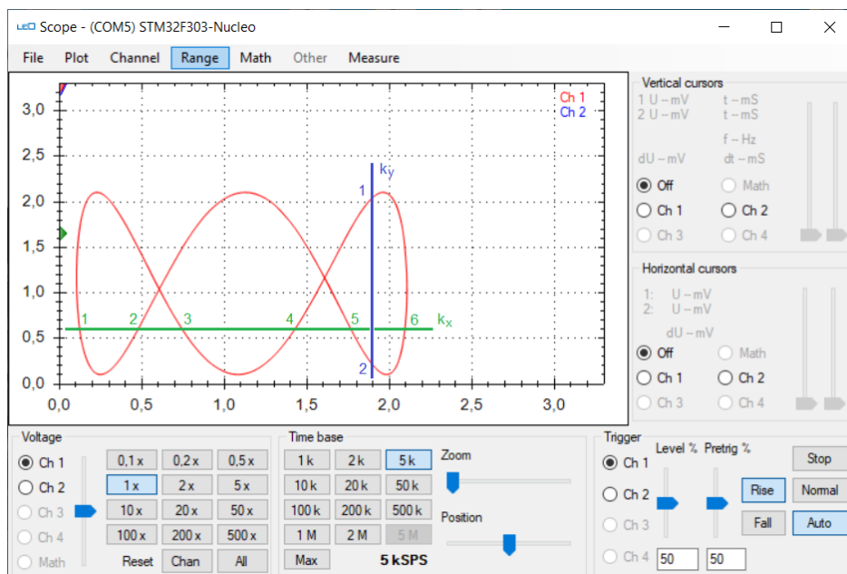
Obrázek 3.13: Popis měření frekvence pomocí Lissajousových obrazců – režim XY
